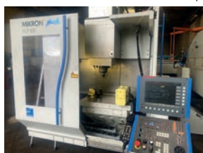
Centre MIKRON VCP600 Heidenhain TNC530 - Diviseur Nikken Broche HSK 20 000 tours
