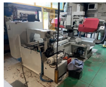
AV Scie à ruban BEHRINGER automatique HBP 310 / 403 GA d'occasion - Chariot aménage Capacité de \varnothing coupe 310 / 400 x 310 mm - Contact RSMO-LG2B Tél : 02 41 56 00 77
