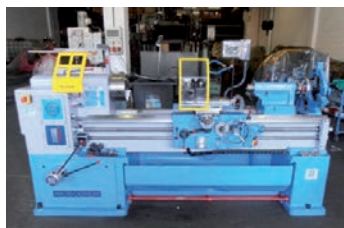
AV Tour parallèle CAZENEUVE Type HB 575 x 1500 Reconstituit - Distance entre pointe : 1500 mm - Hauteur de pointe : 250 mm - \varnothing admis au-dessus du banc : 575 mm \varnothing admis au-dessus du chariot : 340 mm - Alésage broche : 52 Conicité de la contre pointe : CM5 - Course maxi du chariot transversal : 400 mm - 18 vitesses de broche : 25 à 2000 tr/min - Puissance moteur de broche : 8,8 kw - Dimensions machine : 2400 x 1180 x 1350 Protection mandrin Tél : 06 07 68 86 74 Mail : lgmo95@orange.fr
