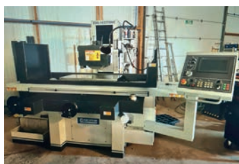
AV Rectifieuse plane EQUIPTOP ESG 1632 TDNC - Capacité : 800 x 400 mm - Tél : 06 63 65 11 01
