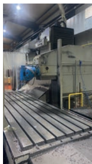
Fraiseuse KIHEUNG U1000 TNC426 Heidenhain Tête auto changeur Courses 3000 x 1000 x 1600 mm
