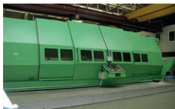
AV Centre de tournage perçage fraisage CNC WFL MILLTURN M120-5000 - Année 2009 Siemens 840D Power Line - \varnothing maxi : 1140 mm - XYZ : 900 x 650 x 5370 mm - Nez de broche de tournage B20 - 60 kW 1000 tr/min - 7180 Nm - Axe C Broche de fraisage S3 : 55 kW 3200 tr/min - 730 Nm - Chariot avec barre d'alésage \varnothing : 220 x 1830 mm - Contre pointe - 2 chariots pour lunette - 60 outils HSK100 - Centrale d'arrosage Convoyeur à copeaux Aspiration Tél : 05 61 84 93 01
