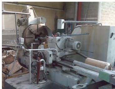
AV Rectifieuse cylindrique intérieure de marque COLMANT WEMEX - Type SIP 400 x 500 / 710 - Alésage maxi à rectifier : 630 mm - Alésage mini à rectifier : 30 mm - Profondeur maxi à rectifier suivant la pièce et l'instrument de mesure : 500 / 710 mm - Course maxi de la table : 800 mm - Equipements : Plateau 4 mors à serrage indépendant ø 800 mm, lunette ø 400 mm, 12 portes meule, 1 caisse de meules - Prix de vente : 8 000€ HT - Tél : 04 42 96 48 00 ou 06 14 35 65 27
