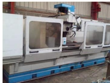
AV Rectifieuse plane CNC de marque G.RASTELLI - Type PL7.16CN - Surface utile de la table : 700 x 1600 mm Course longitudinale : 1870 mm Course transversale : 700 mm - Distance maxi entre la table et l'axe de broche maxi : 850 / 1150 mm - Vitesse de rotation de la broche : 3000 tr/mn Puissance moteur : 15 kw - Plateau magnétique : 1580 x 610 mm - Prix de vente : 12 000€ HT - Tél : 04 42 96 48 00 ou 06 14 35 65 27
