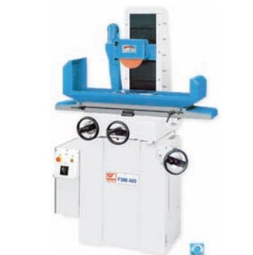
AV Rectifieuse plane FSM 480 - Mouvement long. table : 480 mm - Mouvement transv. : 230 mm - Distance broche / table : 470 mm - Tél : 05 62 23 73 33
