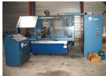
AV Rectifieuse intérieure TRIPET - TST 201 - CNC 2000 - Course Z : 480 mm Hauteur de pointe : 158 mm - Dressage Dispositif arrosage filtr. pap. - Broches : 24 000, 45 000, 75 000 t/mn - Tél : 03 88 98 92 00
