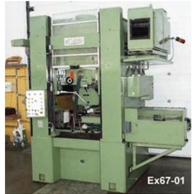
AV Rectifieuse d'engrenages REISHAUER RZP 200 n° 2054 - Ø diam de tête max : 120 mm - Longueur de rectification max : 50 mm - Meule Ø max : 400 mm - Alésage : 203 mm - Tél : 04 50 24 07 00
