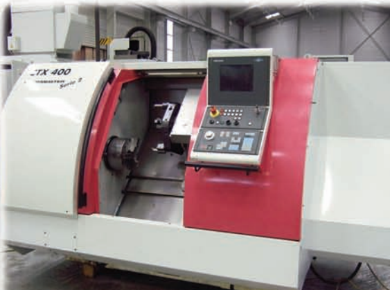
GILDEMEISTER CTX 400 Série 2 - HEIDENHAIN PILOT HP=420 EP=635 Tourelle 12 postes
