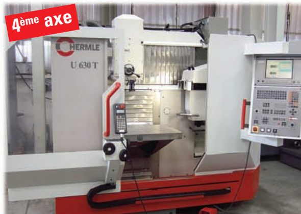
HERMLE U 630 T - HEIDENHAIN TNC 410 X=630 Y=500 Z=500 4 ème axe NIKKEN
