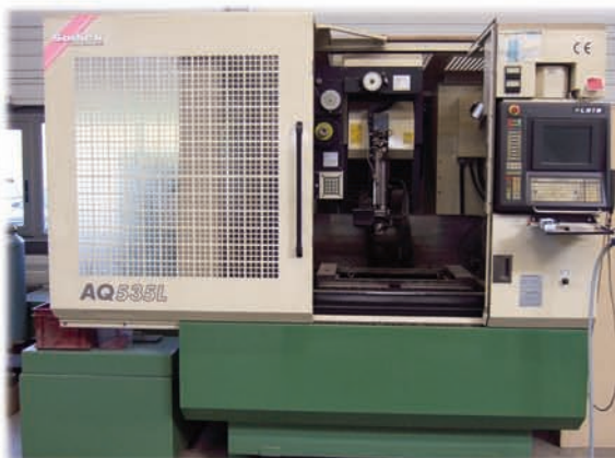
SODICK AQ 535 L - LN1 W X=550 Y=350 Z=300 - Immersion Bac : 920 x 620 x 500
