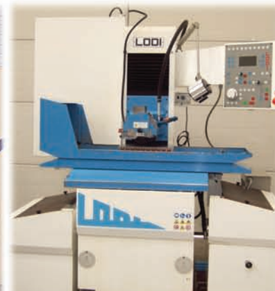
LODI T40.20CN X=500 Y=200 Z=510 Prise de passe automatique
