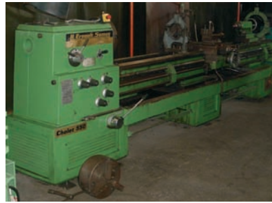
Tour conventionnel ERNAULT SOMUA CHOLET 550 Entre-pointes 3000 mm - ø sur le banc 550 mm ø au dessus du trainard 280 mm Passage de broche ø 51 mm
