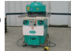
Encocheuse / poinçonneuse IMAC type KVA 200/6 Dimensions table 1000 x 800 mm Capacité encochage : lg couteaux 205 x ép 6 mm ø maxi de poinçonnage 60 mm
