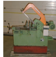
Scie alternative KASTO type EBS133 ø maxi de coupe 200 mm Descente automatique Inclinaison 0-45°
