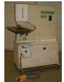
Poinçonneuse hydraulique GEKA type PUMA 50 - HYD Puissance 50 T Capacité de perçage ø 27 x 13 mm Pofondeur col de cygne 500 mm
