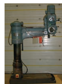
Perceuse radiale GSP type 405D 100 Course du bras 1000 mm Blocage hydraulique Cône CM4 ø de la colonne 250 mm
