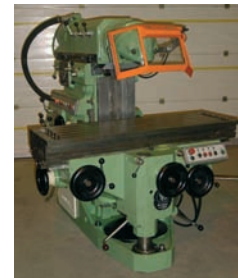
Fraiseuse universelle HURON type NU4 X 1100 - Y 700 - Z 500 mm Cône SA40 Vitesses de 30 à 2066 t/min Table 1435 x 460 mm Armoire électrique neuve
