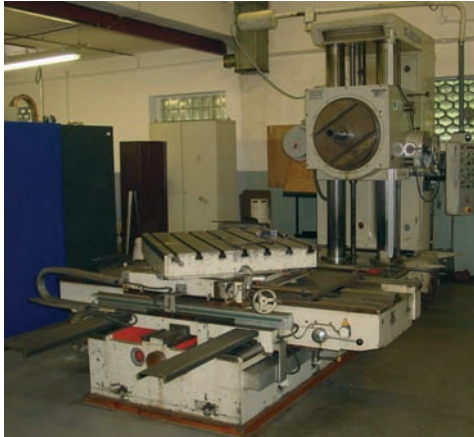
Aléuseuse SCHARMANN type FB100A ø broche 100 mm - Cône SA50 X 2500 - Y 1200 - Z 1200 mm - Plateau ø 650 Visue 3 axes
