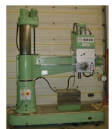
Perceuse radiale KOLB type KR55 Course de bras 1500 mm ø de la colonne 315 mm Fonction perçage/taraudage Machine quasi neuve (-100h de travail)
