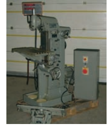
Fraiseuse DECKEL type FP1 X 300 - Y 150 - Z 350 mm Cône CM4 Vitesses de 19 à 1900 t/min Table 600 x 210 mm
