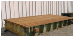
Taques en fonte rainurée 4650 x 2700 x épaisseur 630 mm 4 rainures en T 50 x 28 mm Poids : 15 T
