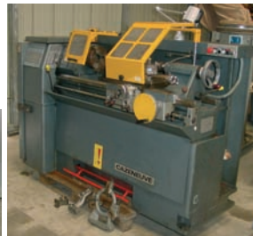
Tour conventionnel CAZENEUVE 360 HBX Entre-pointes 750 mm ø sur le banc 400 mm ø sur le dessus du trainard 200 mm Passage de broche ø 42 mm
