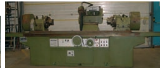
Rectifieuse de vilebrequin RIBON CCG 1500/500 ø 500 mm maxi Entre-pointes 1500 mm Meule ø 600 x ø 200 x ép 35 mm
