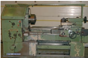
Tour parallèle LEFEBVRE MARTIN type LM550 Entre-pointes 1000 mm ø sur le banc 550 mm ø au dessus du trainard 285 mm Passage de broche ø 80 mm
