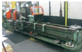
Tour parallèle DEMOOR Double mandrin Entre-pointes 3000 mm ø sur le banc 490 mm ø au dessus du trainard 305 mm ø passage de broche 100 mm
