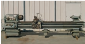
Tour parallèle VDF type V3 Entre-pointes 3000 mm ø sur le banc 540 mm ø au dessus du trainard 300 mm Passage de broche ø 32 mm
