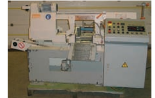
Scie à ruban KASTO type SBA 260 AU ø maxi de coupe dans le rond : 260 mm Amenage automatique course : 700 mm Vitesse de coupe : de 18 à 110 m/min Convoyeur à copeaux
