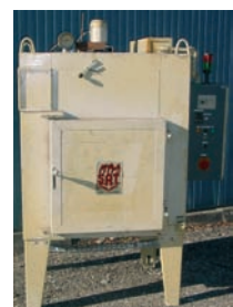
Four / étuve de recuit SAT Température maxi 300° C Dimensions intérieures 750 x 860 x 750 mm
