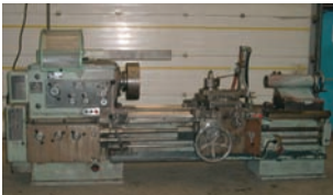
Tour parallèle STANKO type 1M63B Entre-pointes 1400 mm ø sur le banc 750 mm ø au dessus du trainard 380 mm Passage de broche ø 80 mm
