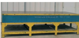
Marbre lisse en fonte 3500 x 1500 x épaisseur 420 mm + nombreux autres marbres lisses disponibles Liste sur simple demande
