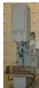
Rodeuse intérieure verticale NAGEL VS 8-50 ø 10 à 150 mm Course 450 mm Rotation : 80 à 400 t/min
