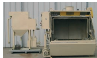
Laveuse / dégraisseuse PERO type ROBOMAT 7A Longueur utile 1600 mm Largeur utile 1040 mm Hauteur utile 960 mm Poids maxi charge 1500 kg
