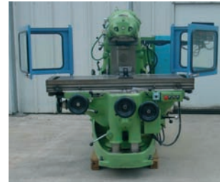
Fraiseuse HURON type KU5 X 1300 - Y 700 - Z 500 mm Cône SA40 Vitesses de 30 à 2066 t/min Table 1630 x 420 mm Visue 3 axes HEIDENHAIN
