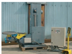
Positionneur de soudure SAF MEMOREX Capacité maximale : 250 kg Plateau : ø 600 mm Variateur de vitesse
