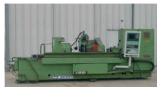
Rectifieuse cylindrique extérieure SCHAUDT ø 400 mm maxi Entre-pointes 2300 mm CN Siemens Sinumerik 840D Année 2000
