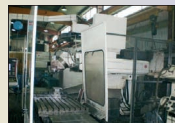
Fraiseuse CNC HURON SXD 733 Courses 3000 x 1000 x 1000 Tête auto - Magasin CNC Num 1060
