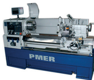
AV Tour conventionnel C460 - Banc plat monobloc haute rigidité - Broche en acier trempé montée sur roulements coniques de précision - Frein à pédale de broche - Diamètre au dessus du banc : 460 mm - Course du chariot transversal : 300 mm - Course du chariot supérieur : 160 mm - Tourelle manuelle carré à 4 postes - Fourreau : ø 59 mm, course : 127 mm Tél : 01 69 17 12 12
