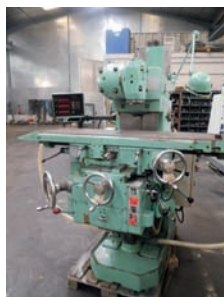
AV Fraiseuse DUFOUR - Type 231 - Table : 1300 x 325 - Courses : 900 x 300 vert. 565 - Visu 3 axes - Tél : 03 25 31 92 68 Mail : lemoine.mo@wanadoo.fr AV Fraiseuse CORREA L30/43 - Axe X : 4300 mm - Axe Y : 1200 mm - Axe Z : 2000 mm - CN Heidenhain 415 - Tél : 07 70 84 51 43
