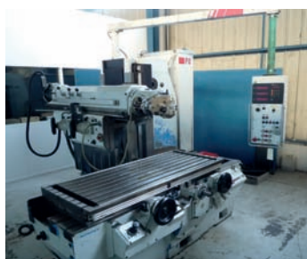
AV Fraiseuse HURON PU 551 - Année 1984 Surface de la table : 1635 x 700 mm - Courses XYZ : 1300 x 1000 x 1000 mm - Nombre de vitesses de broche : 27 - Gamme des vitesses : 30 à 2066 tr/min - Cône de broche : SA 40 + Visu 3 axes Heidenhain - Variateurs d'avances Tél : 04 77 73 00 82 AV Fraiseuse ALCERA 6 S - 640 x 230 x 430 Très bon état - Tél : 07 98 20 50 72
