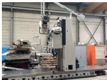
AV Fraiseuse HURON LU - Visue - Cap : 4000 x 1000 x 2000 mm - Table rotative - Taques Tél : 06 63 65 11 01
