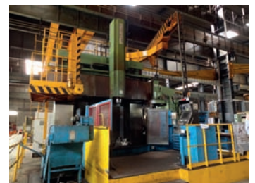
AV Tour vertical CN Siemens 840D - Année 2012 - Diam : 2000/2500 x hauteur usinable 2500 - Z : 1750 - Moteur plateau : 75 Kw - Rotation : 2 à 162 tr/min - Changeur 12 pos. Rectif - Convoyeur - Carters Tél : 06 88 94 32 50 Mail : info@mfl-industrie.com
