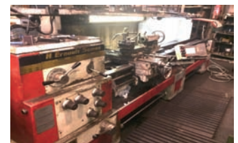
AV Tour parallèle ERNAULT Somua - Type Cholet 500 x 2900 - Hauteur de pointes : 250 mm - Entre pointes : 2900 mm - Banc semi rompu - Alésage de broche : 52 mm Diamètre admis sur coulisse transversale : 230 mm - Diamètre de passage : 550 mm - Visuali- sation 2 axes Heidenhain - Tourelle Multifix type C + Porte outils - Lunettes fixes Tél : 06 07 68 86 74 - Mail : lgmo95@orange.fr
