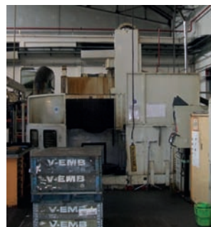
AV Tour vertical CNC BERTHIEZ TFM 100 Rétrofit numérique en 1997 avec Num 1060 Diamètre du plateau : 1000 mm - Broche : 37 kw - ø usinable : 1240 mm - Course verticale : 1000 mm - Course transversale : 1450 mm Section du coulant : 200 x 200 mm - Changeur d'outils 12 positions - Tél : 04 77 73 00 82
