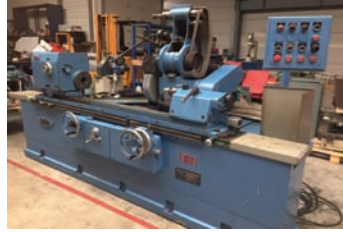
AV Rectifieuse inter exte Construction de Clichy - Type 5023N - Hauteur de pointes : 190 mm - Entre pointes : 1000 mm - Appareil intérieur basculant - Diamètre maxi rectifiable : 370 mm - Diamètre de meule : 455 mm - Largeur de meule : 80 mm - Lunette 3 touches - Lunette 2 touches - Plateau - Porte diamant rabattable - 2 portes meules - Bac d'arrosage avec système de démagnétisation Prix : 7 500 Euros HT - Tél : 06 07 68 86 74 ou 01 34 08 42 44
