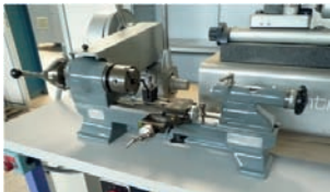
AV Tour conventionnel SCHAUUBLIN 70 sur établi - Passage sur le banc : 130 mm - Distance entre pointes : 275 mm - Armoire électrique neuve - Chariot croisé - Machine en très bon état - Tél : 04 77 73 00 82
