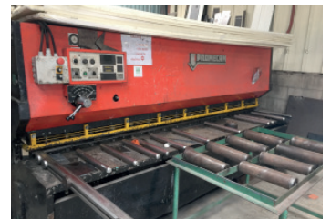
AV Cisaille guillotine hydraulique PROMECAM Type BRG 3000Z6 - Longueur de cisailage : 3100 mm - Epaisseur : 6 mm - Butée arrière électrique : 1020 mm - Profondeur du col de cygne : 350 mm - Cadence : 16 à 64 coups/mn Réglage du jeu entre lames et de l'inclinaison Tél : 06 07 68 86 74 Mail : lgmo95@orange.fr
