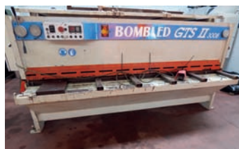
AV Cisaille guillotine BOMBLED GTS 3008 Capacité : 3050 x 8 mm - Butée arrière programmable : 1000 mm Tél : 05 61 78 85 85
