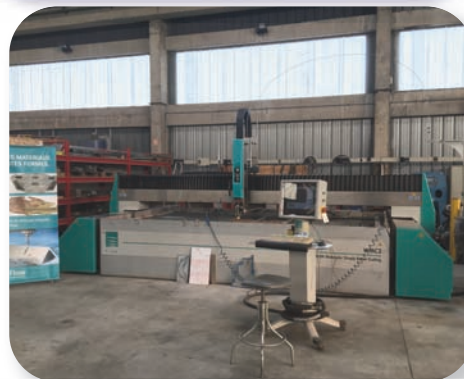
Découpe jet d'eau FLOW WMC2 4020 2000 x 4000 mm Pompe 4150 bars
