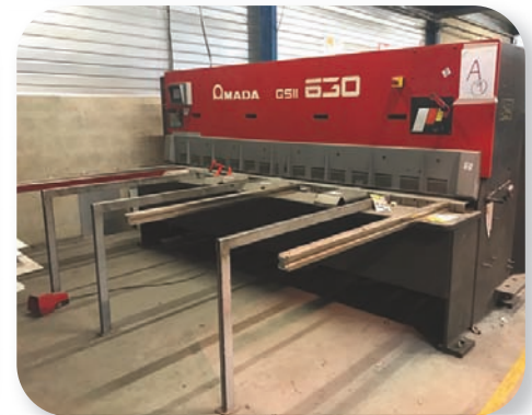
Cisaille AMADA GS II 630 3000 x 6 mm Avec support tôle fine
