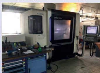
CUV DMC 850 De 2016 Courses 850 x 600 x 600 14 000 tr/min - Heidenhain 640 Super état
