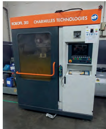
AV Machine électro-érosion par fil CHARMILLES Robofil 300 Exceptionnelle machine d'un centre de formation, très peu utilisée - Axe X (longitudinal) : 400 mm - Axe Y (transversal) : 250 mm - Axe Z (vertical) : 400 mm Longueur max. de la pièce : 850 mm - Largeur max de la pièce : 500 mm - Hauteur max de la pièce : 400 mm - Poids max de la pièce : 500 kg - Longueur du bac : 900 mm - Largeur du bac : 800 mm - Hauteur du bac : 400 mm - Renfilage auto Dimensions (L x l x h) : 1800 x 1600 x 2230 - Poids : 2500 kg Tél : 06 07 68 86 74 Mail : lgmo95@orange.fr
