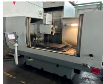
AV Rectifieuse plane ELB - Capacité : 1000 x 600 mm Tél : 06 63 65 11 01
