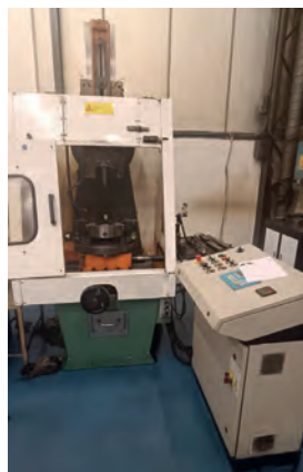
AV Mortaiseuse CAMS automatique - Course : 300 mm Tél : 06 63 65 11 01
