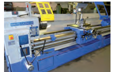
AV Tour parallèle CAZENEUVE Type HB 725 x 4000 - Reconstitue Distance entre pointe : 4000 mm Hauteur de pointe : 315 mm - ø admis au-dessus du banc : 725 mm ø admis dans le rompu : 920 mm ø admis au-dessus du trainard : 670 mm - ø admis au-dessus du chariot : 400 mm - Alésage broche : 81 - Conicité de la contre pointe : CM6 - Course maxi du chariot transversal : 400 mm - Nombre de vitesse de broche : 18 - Rapides longitudinales
