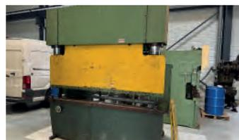
AV Presse plieuse LVD PPS 150/25 - Occasion - Puissance : 150 tonnes - Longueur utile : 2500 mm - Col de cygne : 250 mm - Entre montants : 2050 mm - Butée arrière manuelle : 600 mm - Poinçons mauvais état - Matrice utilisable
