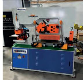
AV Poinçonneuse universelle ACCURL - Type IW 60 S **Machine neuve** - Double poste Diamètre et épaisseur max. : 28 x 20 mm - Col de cygne : 310 mm - Coupe rond : 40 mm Coupe carré : 38 mm - Cornière : 130 x 130 x 12 mm - Fers plats : 350 x 15 mm - Puissance moteur : 5,5 kw - Poids : 1780 kg Dimensions machines : 1700 x 800 x 1710 mm - Puissance : 60T - Avec jeu de 10 poinçons matrices  $\varnothing$  : 8-10-12-14-16-18-20-22-24-26 jeu de 3/10
