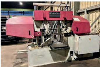
AV Scie ruban automatique de production BEHRINGER type HBP 530 A - Année 2013 Double colonne - Construction lourde renforcée - En fonte grise - ø de coupe maxi : 530 - Dimensions de coupe maxi carré : 520 x 530 mm Dimension du ruban : 7200 x 54 x 1,6 - Variateur de fréquences : 15 à 110 m/mn - Aménage automatique par vis à billes : 500 mm - Tél : 03 80 78 72 62
