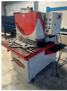
AV Encocheuse SIMASV AV 180 - Épaisseur acier maxi : 6 mm - Épaisseur inox maxi : 4 mm - Angle mini : 30° - Angle maxi : 180° - Longueur utile : 255 mm - Largeur utile : 255 mm - Réglage de jeu coupe automatique - Longueur de table : 1020 mm - Largeur de table : 800 mm - Cadence : 45 coups/min
