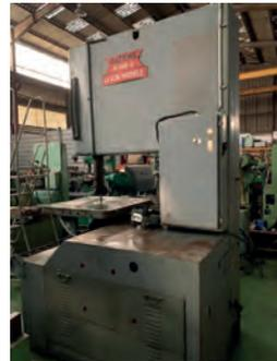
AV Scie à ruban verticale BATENS V900 U - Dimensions de la table : 920 x 910 mm - Col de cygne : 950 mm - Hauteur sous guide : 500 mm
