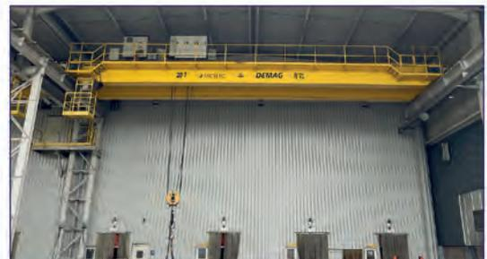
**Z04 14039** - Pont roulant Demag 20 ton x 18 mètres
