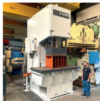
AV Presse à col de cygne LVD 500 ton - Max ouverture : 1240 mm - Course : 680 mm - Table : 2500 x 1250 mm - Puissance : 50 CH - Poids : 40 ton
