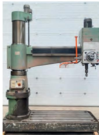
AV Perceuse radiale Z3050 x 161 - Broche Ø : 80 mm - Sortie de broche : 300 mm - Course du bras : 1600 mm - Vitesse de broche : de 25 à 2000 t/min
