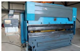
AV Presse plieuse COLLY PS 2000 L 3050 x 125 T - Occasion Année 2001 - Bombage hydraulique - CN Cybelec DNC 800 - Axes CN : Y1, Y2, X1, X2, Z1, Z2, R1, R2 - Serrage hydraulique des poinçons Outillage fractionné - Longueur de pliage : 3050 mm - Puissance : 125 T - Col de cygne : 400 mm Distance entre montants : 2610 mm - Course du coulisseau : 220 mm - Tél : 03 88 68 01 37
