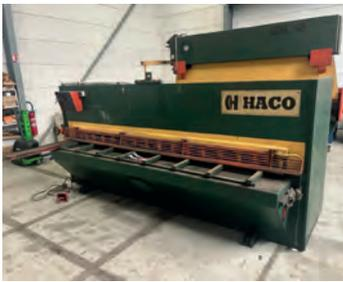
AV Cisaille guillotine hydraulique HACO type TS 3006 - Longueur : 3050 mm Épaisseur de tôle : 6 mm - Angle de coupe : 0,50° - 3° - Puissance totale requise : 10 kw - Poids de la machine : Environ 4800 kg Encombrement : environ 3750 x 1600 x 1650 mm - Cisaille à tôle hydraulique / guidée par guide - Butée arrière électrique : 10-750 mm - Réglage manuel de l'écartement - Protection des doigts à l'avant - Interrupteur à pied - Tél : 06 07 68 86 74 Mail : lgmo95@orange.fr
