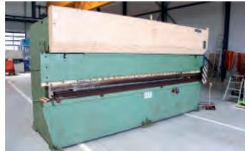
AV Presse plieuse ARNOUX 4450 x 100 tonnes - Occasion Multivé avec ouverture de : 8, 12, 18, 25, 30, 40, 60, 80 mm Longueur de pliage : 4450 mm - Puissance : 100 tonnes Distance entre montants : 4050 mm - Col de cygne : 280 mm
