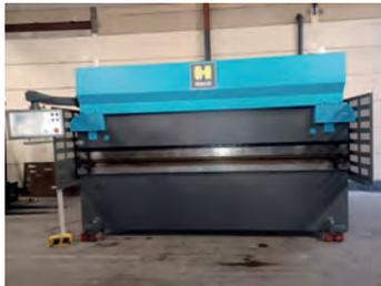
AV Presse plieuse HACO PPM 36135 - Année 2006 Positionneur ATL 595 neuf Butée arrière motorisée X Descente du coulisseau vitesse lente - Serrage manuel Ouverture : 325 mm - Course : 120 mm - Col de cygne : 250 mm - Tél : 05 34 50 26 26
