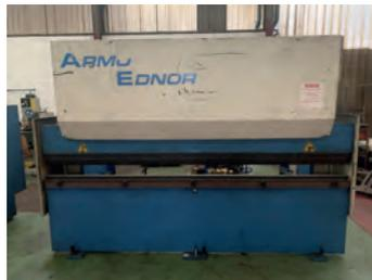
AV Presse plieuse ARMO EDNOR 50T x 3000 - Année 2004 - Puissance : 50T Longueur de pliage : 3000 mm Vitesse de retour : 24 mm/s Vitesse de travail : 8 mm/s Butées électriques - Poinçons et matrice multi-V Tél : 06 75 49 57 65
