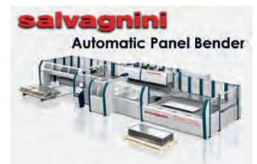
AV Cintreuse de panneaux automatique Salvagnini - Type : P4Xe - 2116 - Longueur de pliage maximale : 2180 mm Longueur min/max de la tôle : 285/2495 mm - Largeur min/max de la tôle : 190/1524 mm Hauteur maximale de la pièce : 165 mm
