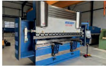
AV Presse plieuse BOSCHERT SPB 3200 - Occasion - Année 2006 - CN Cybelec DNC 880 S - Longueur de pliage : 3100 mm - Puissance : 200 tonnes Distance entre montants : 2560 mm - Col de cygne : 400 mm Course butée arrière motorisée : 800 mm - Course du coulisseau : 225 mm - Hauteur de travail : 1050 mm - Largeur de la table : 90 mm - Tél : 03 88 68 01 37
