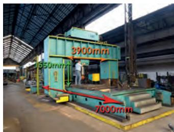
AV Presse à dresser mobile LVD 400 ton - Passage entre montants : 3900 mm - Table : 7000 x 3200 mm - 14 pistons de contre-pression individuels dans la table (3 ton cap) - Poids totale : 85 ton
