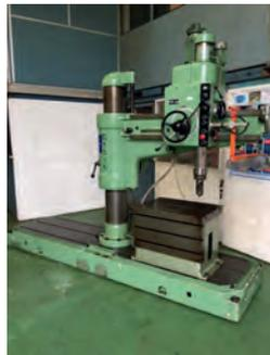
AV Perceuse radiale GYSIN RH40 - Reconstituée en 1993 Course de la broche : 300 mm Distance max outil-table : 270-1270 mm - Cône de broche : CM5 - Longueur de bras : 1290 mm - ø de perçage : 45 mm Vitesse de rotation de broche : 21-1800 Tpm
