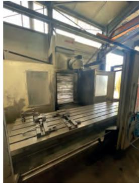
AV Fraiseuse Anayak de 2007 CN Fanuc - X 2500 x Y 1000 x Z 1100 mm - Table : 2700 x 850 mm - Broche : 26 kW ISO 50 - Tête auto : 4000 tr/min Arrosage centre broche - Dispo immédiate
