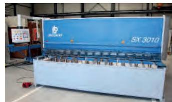
AV Cisaille BOSCHERT SX 3010 Occasion - Positionneur ELGO Réglage jeu entre lames électrique - Longueur de coupe : 3100 mm - Épaisseur max acier : 10 mm - Épaisseur max inox : 6 mm - Nombre de serre tôle : 15 - Course butée arrière motorisée : 1000 mm - Support/ accompagnateur arrière de tôle fine pneumatique et monobloc longueur : 700 mm Butée d'équerre : 1500 mm + 2 supports : 1000 mm Tél : 03 88 68 01 37
