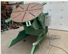
**Positionneur de soudure
