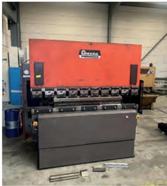
AV Presse plieuse hydraulique AMADA - Type ITPS 5020 Force : 50T - Longueur : 2000 mm - Entre montants : 1600 mm - Course : 105 mm Profondeur du col de cygne : 400 mm - Puissance : 6,5 Kw Poids approximatif : 3 450 kg Encombrement : 2300 x 1180 x 2040 mm - Tél : 06 07 68 86 74 Mail : lgmo95@orange.fr
