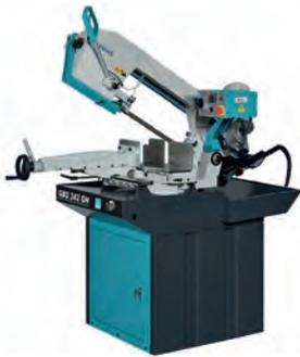
AV Scie à ruban à descente par gravité IMET GBS 270 GH AUTOCUT - Année 2025 - Grand plateau d'appui et rotation avec archet - Serrage manuel rapide de l'étau - Coupe à 45° à gauche et 60° à droite Arrosage intégré
