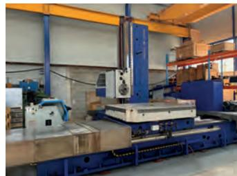
AV Aléseuse TOS WHN 13 Année 2014 - CN Heidenhain iTNC530 - X 3500 x Y 2000 x Z 1250 x W(broche) 800 mm Table : 1800 x 2200 mm - Charge : 12 t - B continu - Rotation : 3000 tr/min - Arrosage centre broche - Broche : 130 mm TBE - Visible en notre atelier de Saint-Chamond (42400) Tél : 04 77 29 56 74 Email : info@mfl-industrie.com
