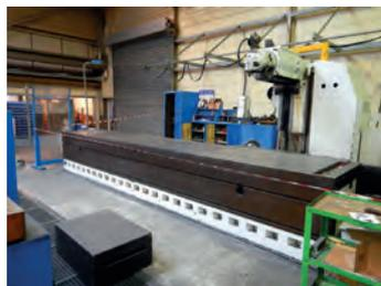
AV Fraiseuse à colonne mobile Huron - X : 4500, Y : 1000, Z : 1000 mm - ISO 40 - 2066 rpm Lecture digitale - Table : 6155 x 1015 mm - Poids : 12 ton
