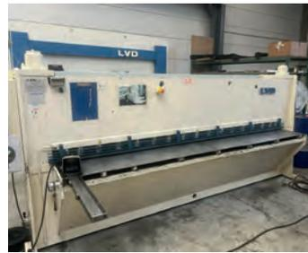
AV Cisaille guillotine hydraulique LVD type HSL 31/6 Longueur de pliage : 3100 mm Épaisseur : 6,35 mm - Presse tôle hydraulique - Butée arrière électrique gérée : 650 mm Réglage de l'angle de coupe électrique - Bras support avant Puissance moteur : 7,5 kw Poids : 5800 kg - Barrière de protection arrière - 4000 x 2000 x 1780 mm Tél : 06 07 68 86 74 Mail : lgmo95@orange.fr
