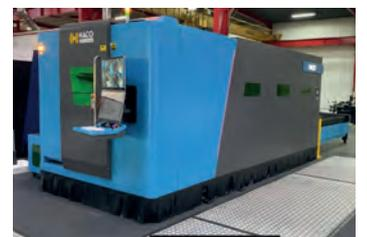
AV Table de découpe laser fibre HACO GS 3015 CEW - Année 2025 - Commande numérique FSCUT 4000 - Tête de découpe BUCCI BLT 421 - Source RAYCUS 6 kW - Extraction des fumées SIDEROS ECO 4 - Logiciel HacoSoft laser Tél : 05 34 50 26 26
