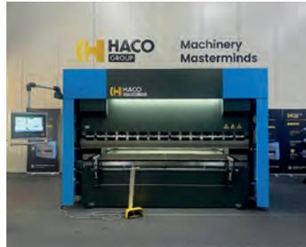
AV Presse plieuse hydraulique HACO OPTIFORM 30150 Année 2025 - Commande numérique EasyBend neuve Armoire électrique neuve Butée arrière X-R - Table de bombage manuelle - Serrage rapide manuel des poinçons Outils type System - Pédale de commande neuve - Col de cygne : 400 mm
