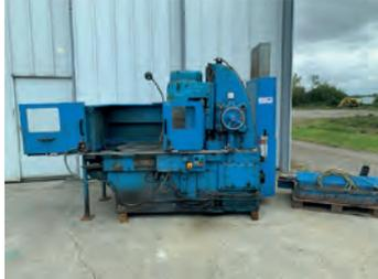
AV Rectifieuse plane à plateau circulaire BLANCHARD N° 18 Plateau circulaire ø : 925 mm Vitesse du plateau : de 5 à 27 t/min - Vitesse de rotation meule : 750 t/min Tél : 03 89 81 71 67 Mail : info@retec-machines.com
