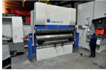
AV Plieuse CNC Trumpf Trumabend 230 ton x 3050 mm - Max ouverture : 1120 mm - Course : 400 mm Cybelec ModEva 10S control - 8 axes : Y1 / Y2 / X / X' / Z1 / Z2 / R / V 30 kW - Poids : 15 ton Mail : info@aptint.com Tél : 0032 9 386 15 71
