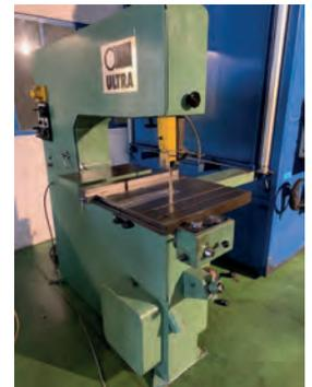
AV Scie à ruban verticale ULTRA RV 763 - Année 1983 Dimensions de la table : 520 x 520 mm - Col de cygne : 763 mm - ø de lame : 2845 x 15 x 0,82 mm - Tél : 06 75 49 57 65
