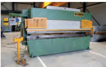
AV Presse plieuse hydraulique HACO PPH 40150 - Occasion - Longueur pliage : 4050 mm - Force : 150 T - Butée électrique - Distance entre montants : 3600 mm - Col de cygne : 250 mm - Tél : 03 88 68 01 37
