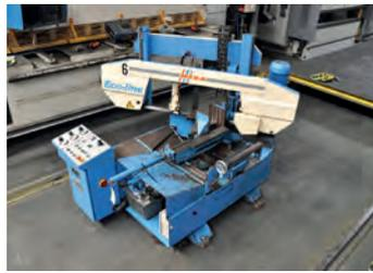
AV Scie à ruban Meba Eco-line dia 335 mm - Scie à ruban semi automatique 90°/45° gauche /30°/45° droite - Max largeur : 500 mm - Max hauteur : 335 mm - Serrage hydraulique Affichage numérique de l'angle de coupe
