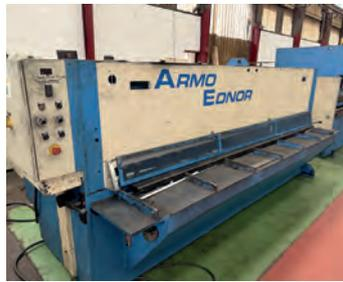
AV Cisaille guillotine ARMO ENDOR Turbo 6 - Année 2004 Longueur de coupe : 3020 mm Épaisseur max : 6 mm - Butées électriques - Réglage entre lames Tél : 06 75 49 57 65
