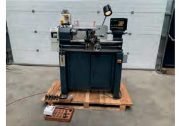
AV Tour parallèle WABECO D6000E - Entre-pointes : 600 mm - ø maxi sur le banc : 270 mm - ø maxi au-dessus traînard : 170 mm - Vitesse de rotation : de 45 à 2300 t/min
