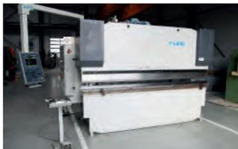
AV Presse plieuse LVD PPI 110/30 - Occasion - 3050 x 110 T - 3 axes - CN Cybelec DNC 880 S - Distance entre montants : 2550 mm - Course : 130 mm Distance max table coulisseau : 310 mm - Largeur de table : 180 mm - Puissance moteur : 14 kw Outillage haut et bas neuf Tél : 03 88 68 01 37
