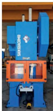
AV Presse col de cygne SANGIACOMO - Puissance : 130 T - Course variable : 16 à 200 mm Réglage motorisé du coulisseau Sécurité hydraulique - Machine rétrofitée - Tél : 06 08 23 70 48
