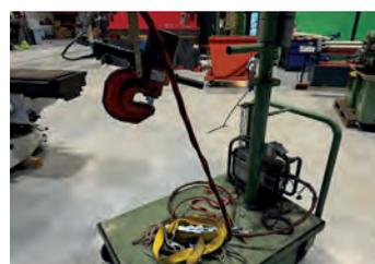
AV Poinçonneuse portable hydraulique 30T APS 70 -  $\varnothing$  maxi : 22 mm - Longueur maxi : 22 x 14 mm - Avec chariot
