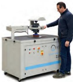
AV Ebavureuse manuelle VG MACHINES DISC ARM GRINDER Année 2025 - Surface de travail : 1300 x 800 mm - Zone d'aspiration : 350 x 250 mm Épaisseur max. des pièces : 110 mm - Rotation de la tête : 180°
