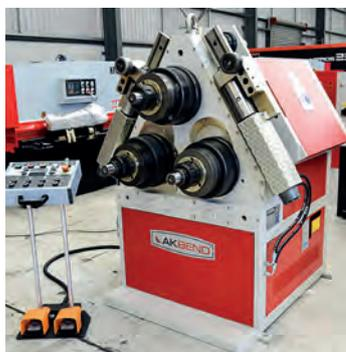
AV Cintreuse à galets Akyapak APK 101 - Dia rouleaux : 315 mm - Dia mandrin : 100 mm Horizontal et vertical - 11 kW
