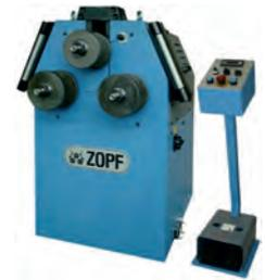
AV Cintreuse universelle motorisée à 2 axes ZOPF ZB 70/2M - Année 2025 Commande à pédale - Axes porte-galets diamètre : 40 mm équipés de roulements à rouleaux coniques - Puissance moteur : 1.1 kW - Livrée avec 1 jeu de galets standards
