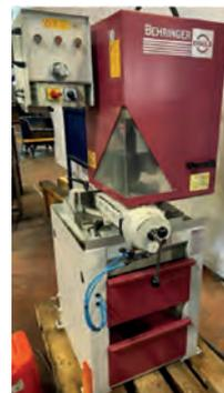
AV Tronçonneuse à fraise-scie semi automatique BEHRINGER EISELE type VMS 350 PV Année 2019 - ø de coupe maxi : 120 Dimensions de coupe maxi à plat : 100 x 170 Coupe d'angles : -45° à +60° Vitesses de coupe : 34/68 tr/mn Construction lourde - Descente verticale sur 2 glissières
