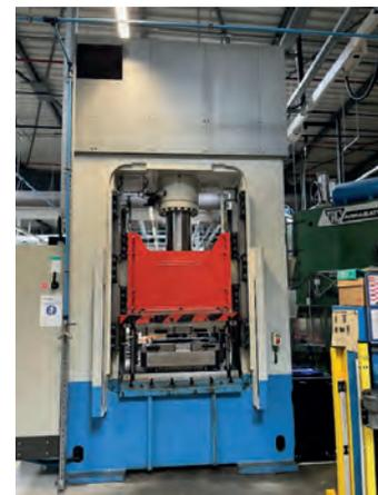
AV Presse hydraulique BLISS Puissance : 200 T - Course : 800 mm - Table : 1250 x 1000 mm Vitesse d'approche : 200 mm/s Vitesse de travail : 14 mm/s Coussin d'emboutissage Automate - Tél : 06 08 23 70 48
