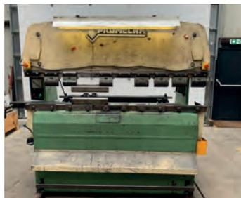
AV Presse plieuse hydraulique PROMECAM RG 35-20 Capacité : 35 T - Longueur de pliage : 2000 mm - Course de la butée arrière : 350 mm - Course du coulisseau : 100 mm Tél : 03 89 81 71 67 Mail : info@retec-machines.com
