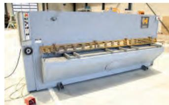
AV Cisaille HACO TS 3006 Occasion - Longueur de coupe : 3050 mm - Épaisseur max acier : 6 mm - Épaisseur max inox : 3 mm - Course butée arrière motorisée : 750 mm Angle de coupe : 0,5° à 3° Hauteur de travail : 770 mm Longueur totale : 3700 mm Largeur totale : 1900 mm Hauteur totale : 1800 mm Tél : 03 88 68 01 37
