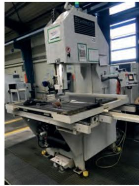
AV Scie à ruban verticale semi automatique de grande capacité BEHRINGER type LPS-T - Année 2018 - Hauteur de coupe maxi : 600 mm Longueur de coupe maxi : 1270 mm - Largeur de coupe maxi : 510 mm - Variateur de vitesses : 10 à 110 m/mn - Construction très lourde en forme de C Table traversante guidée sur 4 glissières linéaires - Charge 2T
