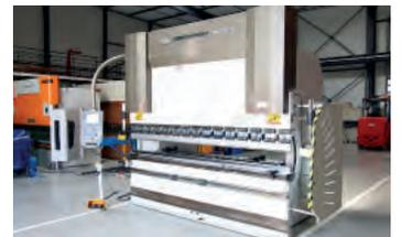
AV Presse plieuse ERMAKSAN CNC AP 3100 x 250 - Occasion Année 2009 - Laser de protection - Table de bombage CN - CN Cybelec Modeva 10S Axes CN : Y1, Y2, X, R - Z1, Z2 manuels - Longueur de pliage : 3100 mm - Puissance : 250 T Distance entre montants : 2550 mm - Col de cygne : 400 mm Course butée arrière motorisée : 800 mm - Course du coulisseau : 250 mm - Passage table / coulisseau : 517 mm - Hauteur de travail : 900 mm - Largeur de la table : 300 mm - Tél : 03 88 68 01 37
