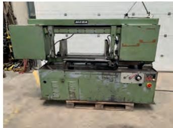
AV Scie à ruban MEBA ø 440 mm - Capacité de coupe rond ø : 440 mm - Capacité de coupe plat : 700 x 300 mm - Fourni avec 2 tables d'aménage
