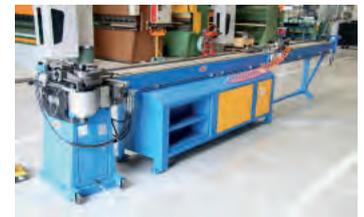
AV Cintreuse par enroulement ERCOLINA MG 030 avec mandrin - Occasion - État proche du neuf - Positionneur manuel - Longueur et angle pour tube : 6000 mm Outillage fourni pour tube  $\varnothing$  48,3 mm - Épaisseur 3,2 mm Rayon de cintrage : 145 mm
