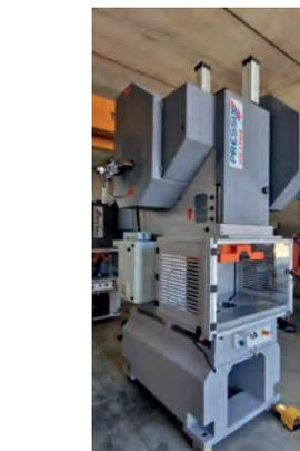
AV Presse col de cygne PRESSIX rétrofitée - Puissance : 100 T - Variateur de fréquence Sécurité hydraulique - Course variable : de 10 à 130 mm
