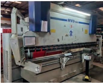
AV Presse plieuse CNC MVD type HAP 40/160 - Année de fabrication : 21/2012 - Axe Y1, Y2, X, R - CNC Delem DA56 Graphique - Laser de protection latéral - Longueur de pliage : 4100 mm - Puissance : 160 TN - Col de cygne : 350 mm Butée arrière motorisée : 700 mm - Positionneur 2 axes Elgo P-8822 - Vitesse d'approche : 100 mm/s - Puissance moteur : 15 kw - Distance entre les montants : 3090 mm - Course du piston : 175 mm - Table inférieure : 120 mm - Marquage CE - Année 2012
