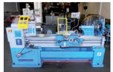
AV Tour parallèle CAZENEUVE Type HB 575 x 1500 Reconstitué - Distance entre pointe : 1500 mm - Hauteur de pointe : 250 mm - ø admis au-dessus du banc : 575 mm ø admis au-dessus du chariot : 340 mm - Alésage broche : 52 - Conicité de la contre pointe : CM5 - Course maxi du chariot transversal : 400 mm - 18 vitesses de broche : 25 à 2000 tr/min - Puissance moteur de broche : 8,8 kw Dimensions machine : 2400 x 1180 x 1350 - Protection mandrin
