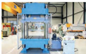
AV Presse hydraulique 4 colonnes SICMI PSQ 300 A Occasion - Puissance : 300 T CN avec écran tactile Siemens neuve - Course du coulisseau : 500 mm - Passage frontal entre colonnes : 1250 mm Passage latéral entre colonnes : 1000 mm - Passage entre table et coulisseau : 1000 mm Vitesse approche / travail : 20 / 2 mm/sec - Dimensions table inférieure : 1250 x 1000 mm Dimensions table supérieure : 1250 x 1000 mm
