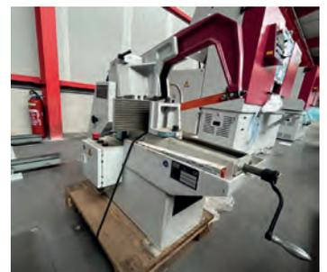
AV Scie alternative semi automatique BEHRINGER type KS 251 HY - Année 2012 Construction lourde renforcée En fonte grise ø coupe maxi : 250 - Dimensions de coupe carré : 230 x 230 mm - Coupe d'angle par pivotement de l'étau : 45° - 2 vitesses de courses (courses / mn) : 65 / 130 Avance de sciage hydraulique Tél : 03 80 78 72 62
