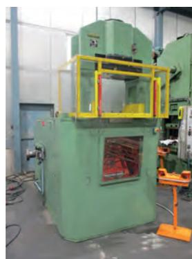
AV Presse à genouillère GRABENER Type GK 360 S Largeur entre montants : 700 Course : 120 m/m - Machine reconstruite - Conforme contrôle APAVE - Visible en fonctionnement
