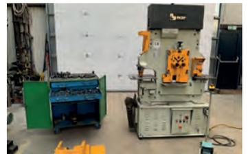
AV Combiné cisaille/poinçonneuse FICEP 604 N - Capacité cisaille : 60 T Poinçonnage : ø maxi 32 x ép 16 mm - Capacité de coupe rond : ø 45 mm - Capacité de coupe carré : 42 mm
