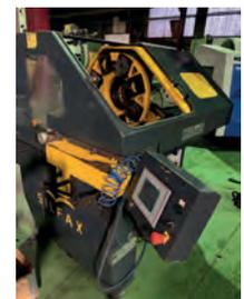
AV Machine à déformer les entrées de tubes CNC SILFAX SFER - Année 2009 - Puissance : 8T - Ø de tube : 50 x 2 mm CNC Siemens 810 D - Tourelle 8 poinçons
