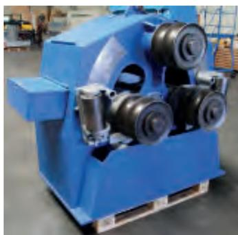
AV Cintreuse à galets ROUNDOR 5 - Occasion - Dimensions : 1900 x 1200 x 1600 - Important lot de galets (standard et ø 110 et 85 mm tubes)
