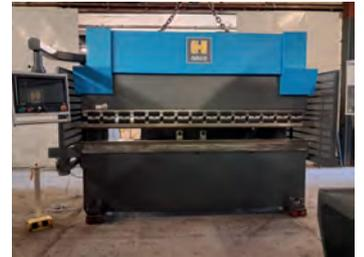
AV Presse plieuse hydraulique HACO ERM 30150 - Année 2003 - Commande numérique EasyBend MT neuve - Armoire électrique neuve - Butée arrière X-R-Z1-Z2 - Table de bombage CNC - Serrage rapide manuel des poinçons - Outils type system - Pédale de commande neuve - Largeur de table : 140 mm - Col de cygne : 400 mm - Tél : 05 34 50 26 26
