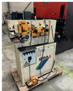
AV Poinçonneuse cisaille universelle GEKA type Microcrop - Puissance de poinçonnage : 36 Tonnes Poinçonnage  $\varnothing$  : 28 x 10 mm Coupe rond :  $\varnothing$  30 - Coupe carrée : 25 - Cisaille pour fer plats : 350 x 6 mm / 200 x 13 mm - Cisaille à profils L à 90° : 80 x 80 x 8 mm - Cisaille à profils L à 45° : 50 x 50 x 6 mm Puissance moteur : 2.2 kw
