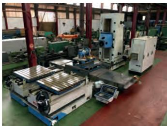
AV Centre de fraisage à table croisée 4 axes JUARISTI TX1-D Année 2007 - Courses XYZ : 2000 x 1500 x 1500 mm Dimensions de la table : 1250 x 1250 (x2) - Changeur d'outils : 40 - Cône de broche : ISO 50 DIN 69872 - CNC Siemens 840 D - Convoyeur - Arrosage centre broche : 20 bars - Changeur de palettes - Tél : 06 75 49 57 65
